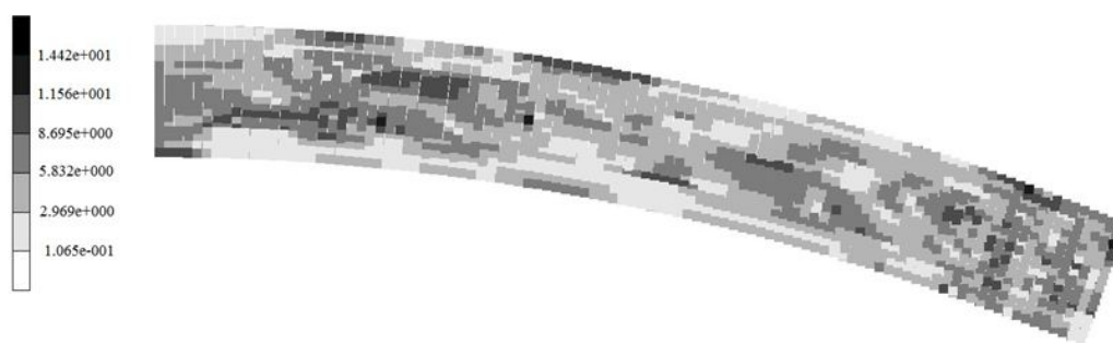
Рис. 2. Термомеханическое деформирование, режим 1: этап 1 – гибка заготовки в прессе при T=20 (время=6 ед.; модуль Юнга=7200; предел текучести=55), этап 2 – нагрев заневоленной заготовки до T=165 (время=0.01 ед.; модуль Юнга=6700; предел текучести=36,8786), этап 3 – выдерживание заневоленной заготовки при T=165 (время=2 ед.; модуль Юнга=6700; предел текучести=36,8786), этап 4 – охлаждение до T=20 (время=0.2 ед.; модуль Юнга=7200; предел текучести=55), этап 5 – медленное снятие пуансонов при T=20 (время=1.8 ед.; модуль Юнга=7200; предел текучести=55)
