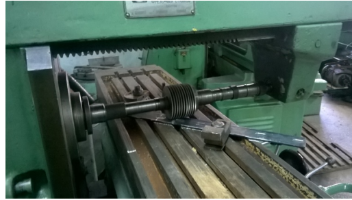
б) фрезерование пазов для увеличения адгезии пластины с клеевой композицией
