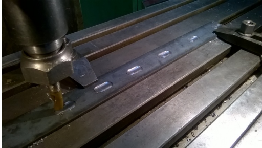
а) фрезерование пазов под тензодатчики
