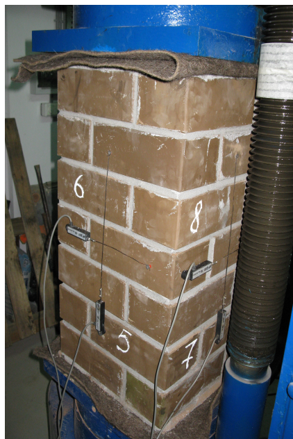
Рис. 2. Испытание образца каменной кладки
