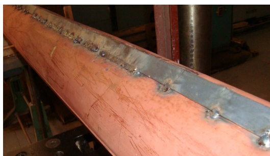
Рис. 4. Образец, усиленный уголком 25x25x4 мм (крепление сваркой) после потери устойчивости/
