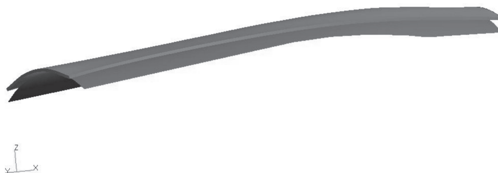
Рис. 2. Остаточная конфигурация заготовки (сверху) после шестой итерации в сравнении с заданной поверхностью.
