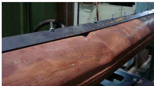
Рис. 3. Форма потери устойчивости образца, усиленного уголком 25x25x4 мм (крепление болтами через 100 мм)
