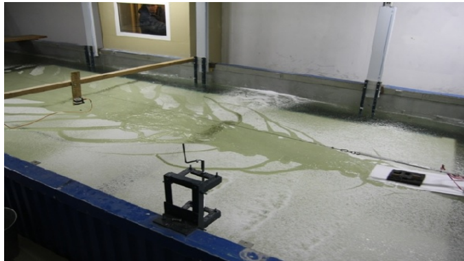
Рис. 3. Характер разрушения модельного льда.
