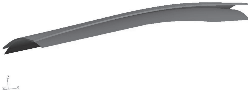
Рис. 1. Остаточная конфигурация заготовки (сверху) после первой итерации в сравнении с заданной поверхностью.
