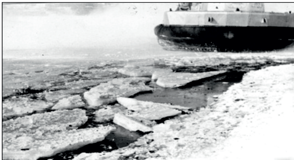
Рис. 1. Разрушение льда СВП "Скат" при выходе на берег
